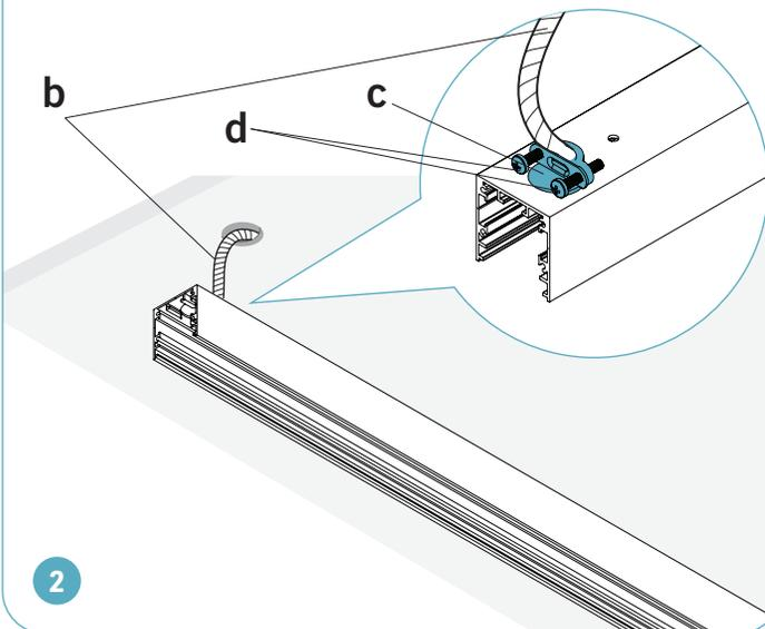
Installer le barre profilé (a) sur la surface choisie avec des ancrages appropriés (e1) et des vis #8 (e2) (non inclus).
